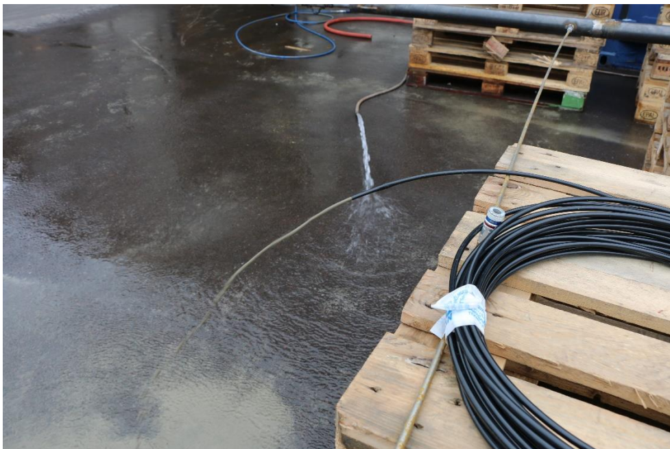
Figur 3-7 Urspolning av injekteringsmedel i 5,5 mm slangen efter ca 2 minuters spolning.
