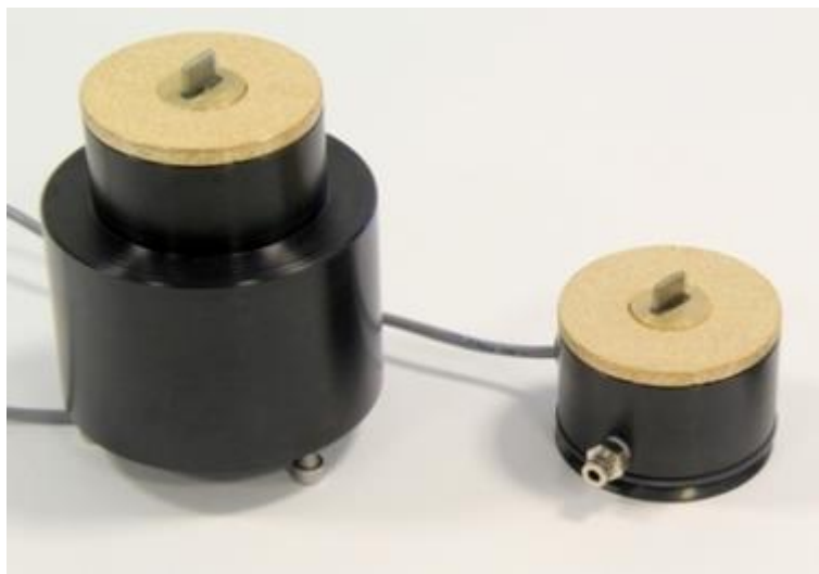
Figur 7. Bender element - sändare och mottagare monterade i topp- och bottenstycke. (Controls group 2019)
