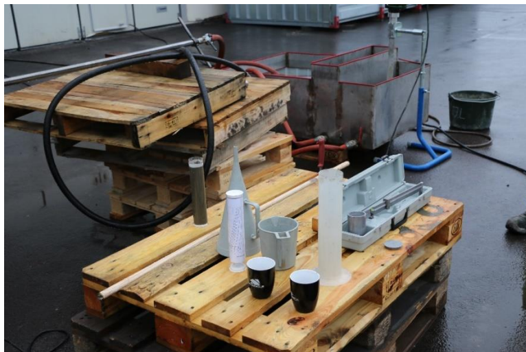
Figur 2-3 Använd mätutrustning för blandningen; Mud-balance, Marchkon och Yield Stick.
