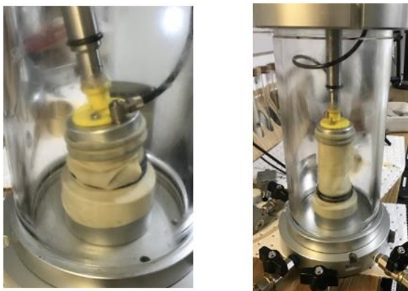
Figur 1. Provmembran monterat i triaxialcellen under testomgång 1. (Hedborg, 2018)
