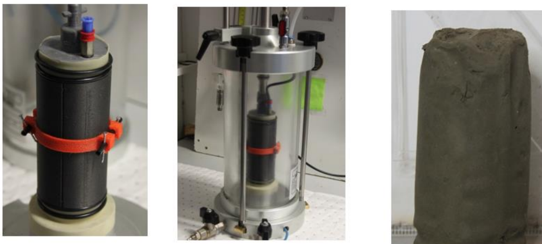
Figur 4. T.v.: Låsanordning med sprintar och fjädrar. Mitten: Provkropp med form och låsanordning inuti triaxialcellen. T.h.: Provkropp efter gjutning. (Foto: Hedborg 2018)
