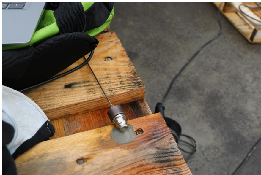
Figur 3-6 Injekteringsmedel ut från 1 mm röret, efter ca 23 minuter. Tryck-loggen indikerar på att injekteringsmedlet plugga igen under ca 20 minuter.
