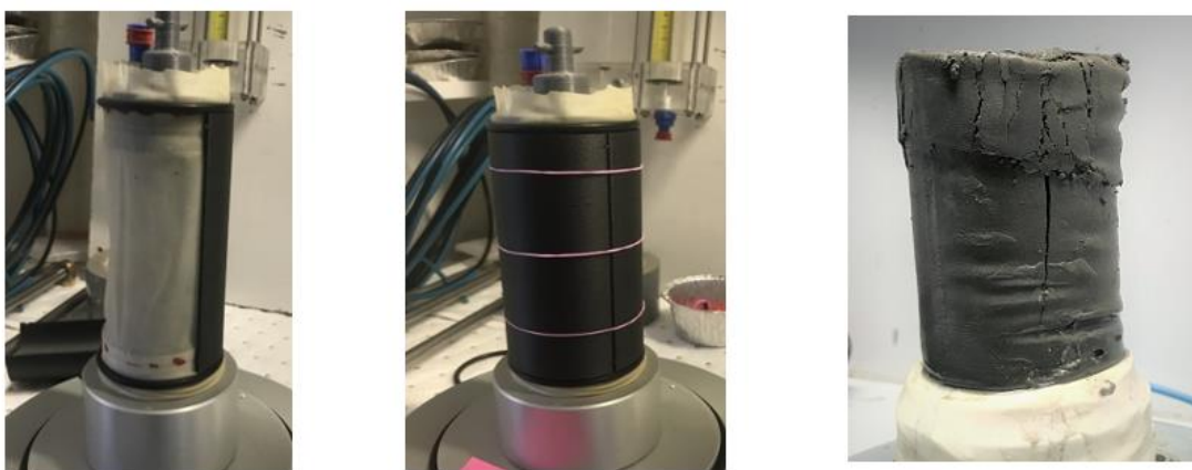
Figur 2. T.v.: Efter montering av provmembran och halva gjutformen. Mitten: Fixering av formen med hjälp av gummiband. T.h.: Deformerad provkropp efter skjuvning i triaxialcell. (Foto: Hedborg 2018)
