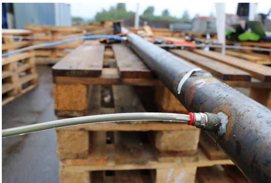
Figur 3-4 Observerad erosion efter ca 40 minuters väntetid i 5,5 mm slangen.
